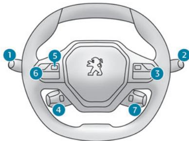
1. Palanca de las luces exteriores/intermitentes
