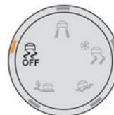
En condiciones excepcionales (desplazamiento del vehículo sobre suelo embarrado, inmovilizado en la nieve, sobre terreno poco estable, etc.), puede resultar útil desactivar los sistemas DSC/ASR para que las ruedas puedan moverse libremente y, de ese modo, recuperar la adherencia.
