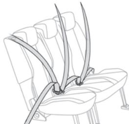
Cada asiento trasero está equipado con un cinturón de seguridad pero sin sistema de pretensión pirotécnico ni limitador de esfuerzo. Tenga cuidado de insertar cada cinturón en su correspondiente enganche.
