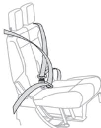
Si el vehículo está equipado con una banqueta delantera, asegúrese de enganchar el cinturón en el enganche pertinente.
