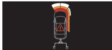
**i** La ayuda trasera al estacionamiento se desactiva automáticamente cuando se conecta un remolque o un portabicicletas a un enganche de remolque instalado según las recomendaciones del fabricante. En ese caso, el contorno del remolque se visualiza en la parte trasera de la imagen del vehículo.
