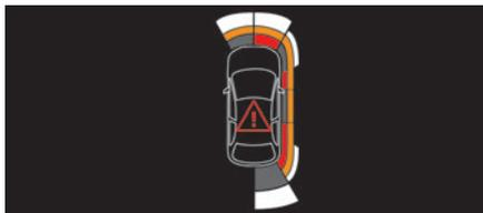
Con cuatro sensores adicionales situados a los lados de los parachoques, el sistema registra la posición de los obstáculos durante la maniobra y los señaliza cuando se encuentran a los lados del vehículo.
