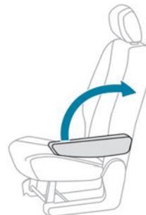
► Para colocar el reposabrazos en posición vertical, levántelo hasta que quede fijado en esta posición.
