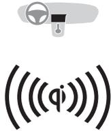
Este sistema permite la carga inalámbrica de dispositivos portátiles, como un smartphone, mediante el principio de inducción magnética conforme a la norma Qi 1.1.
