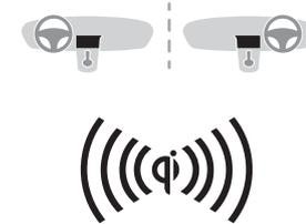
Este sistema permite la carga inalámbrica de dispositivos portátiles, como un móvil, mediante el principio de inducción magnética conforme a Qi.
