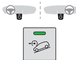
▶ Para seleccionar el sistema, a velocidades inferiores a 50 km/h, pulse este botón hasta que su testigo verde se encienda; este testigo se enciende en gris en el cuadro de instrumentos.
