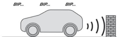
El sistema indica la presencia de obstáculos tanto en la zona de detección de los sensores como en la trayectoria del vehículo, que está definida por la dirección del volante.
