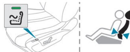
Esta función, que sólo funciona con el motor en marcha o con el sistema Stop & Start en modo STOP, realiza un masaje lumbar.
