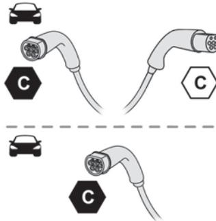
Etiqueta de identificación **C** en el conector de carga (extremo del vehículo) y en la toma (extremo del cargador).
