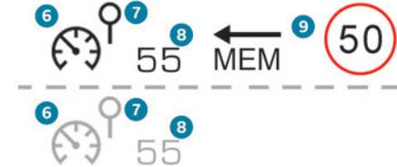
6. Indicación de activación/interrupción del limitador de velocidad
