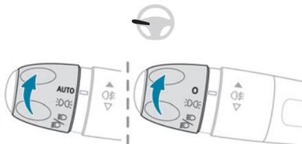
**AUTO** Encendido automático de luces/luces diurnas
