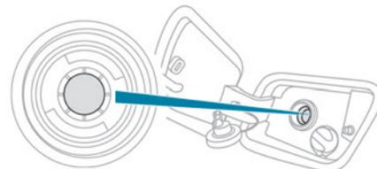
Cuando se inserta una boquilla de llenado de gasolina en la boca del depósito de carburante de un vehículo diésel, entra en contacto con la tapa. El sistema permanece bloqueado, impidiendo el llenado.
