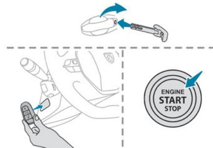
► Introduzca la llave mecánica (integrada en el mando a distancia) en la cerradura para abrir el vehículo.
