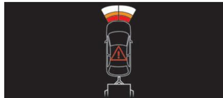
**i** La ayuda al estacionamiento trasera se desactiva automáticamente cuando se acopla un remolque o un portabicicletas a un
