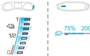
El nivel de carga real de la batería de tracción y la autonomía restante se muestran de forma continuada cuando se arranca el vehículo.
