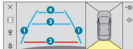
Según contexto, en la pantalla se muestra la zona que hay detrás o delante del vehículo. Las líneas azules (en la parte trasera) o las líneas naranjas (en la parte delantera) **1** representan la anchura del vehículo, con los retrovisores desplegados; se orientan en función de la posición del volante.
