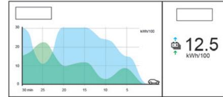
– Gráfico azul: energía consumida directamente de la batería de tracción.
