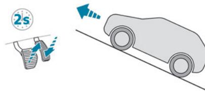
**En pendiente ascendente, con el vehículo parado, éste se mantiene inmovilizado durante un breve periodo de tiempo después de que el conductor suelte el pedal del freno:**
