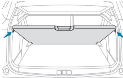
Para mantenerlo en la posición inclinada:
