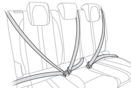
Los asientos traseros cuentan con cinturones de seguridad de tres puntos con carrete de inercia. En función de la versión, las plazas laterales están equipadas con un sistema de pretensión pirotécnica y con un limitador de esfuerzo.
