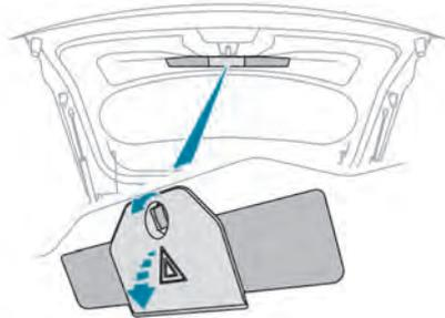
Hay un compartimento para guardar el triángulo de emergencia en el guarnecido interior del portón trasero.
