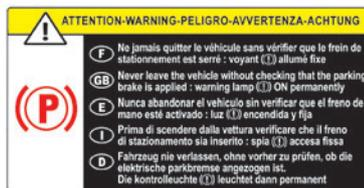
**!** Antes de salir del vehículo, compruebe que el freno de estacionamiento esté accionado: los testigos del freno de estacionamiento en el cuadro de instrumentos y del mando deben estar fijos.
