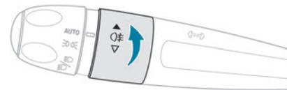
► Gire el mando circular hacia delante o hacia atrás para encenderla o apagarla. Si se produce el apagado automático de las luces (posición "AUTO"), las luces antiniebla y de posición permanecerán encendidas.
