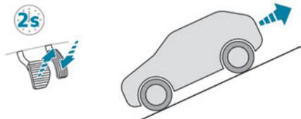
**En una pendiente descendente, con el vehículo parado y la marcha atrás engranada, éste se mantiene inmovilizado durante un breve periodo de tiempo después de que el conductor suelte el pedal del freno.**
