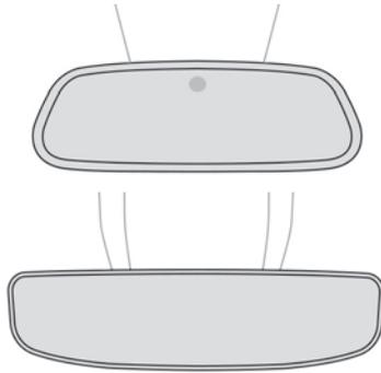
El sistema electrocromático emplea un sensor que detecta el nivel de luminosidad exterior y la procedente de la parte trasera del vehículo, con el fin de conmutar automática y gradualmente entre el uso diurno y nocturno.
