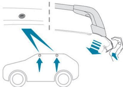
Las barras transversales deben montarse sólo en los cuatro puntos de anclaje situados en el marco del techo. Cuando las puertas están cerradas, estos puntos quedan ocultos.
