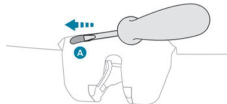
► Introduzca un destornillador pequeño en el orificio **A** de la cerradura para desbloquear el maletero.
