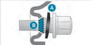
Si el vehículo está equipado con llantas de aleación, las arandelas **A** no entran en contacto con la rueda de repuesto de acero o de tipo "temporal". La rueda se fija en su emplazamiento por las superficies de contacto cónicas **B** de cada tornillo.
