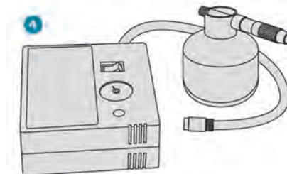
4. Compresor de 12 V con cartucho de sellante y adhesivo de limitación de velocidad Para la reparación temporal de un neumático y el ajuste de la presión.
