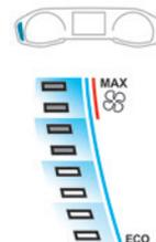
El indicador muestra el consumo de la energía eléctrica de la batería de tracción de los dispositivos de confort térmico del habitáculo. Con cuadro de instrumentos digital, el indicador sólo aparece en el modo "**Personal**". Estos dispositivos son los sistemas de calefacción y aire acondicionado. Este equipamiento puede usarse:
