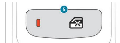
Por la seguridad de los niños, con el contacto dado o el motor en marcha, pulse el mando 5 para desactivar los mandos de las elevallunas eléctricas traseros, independientemente de sus posiciones.
