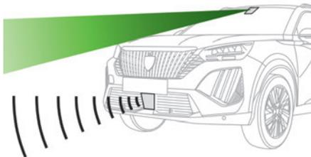
El vehículo está equipado con una cámara multifunción situada en la parte superior del parabrisas y, según versión, un radar situado en el parachoques delantero.
