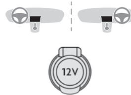
► Conecte un accesorio de 12 V (con una potencia nominal máxima de 120 W) utilizando un adaptador adecuado.
