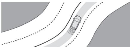
El sistema identifica los límites del carril y corrige la trayectoria del vehículo para mantenerlo dentro del carril y en la posición lateral elegida por el conductor.
