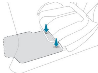
Al realizar el montaje en el lado del conductor, use sólo las fijaciones existentes en la moqueta (un "clic" indica que ha encajado correctamente). Las demás alfombrillas simplemente se colocan sobre la moqueta.
