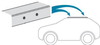
Las barras transversales deben montarse a la altura de las marcas situadas en las barras longitudinales.
