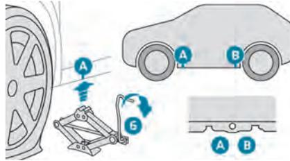
► Coloque la base del gato 6 en el suelo y asegúrese de que queda justo debajo del punto de elevación delantero **A** o trasero **B** previsto en los bajos del vehículo, el más cercano a la rueda que vaya a cambiar.
