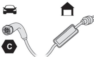
Etiqueta de identificación **C** en el conector de carga (extremo del vehículo).
