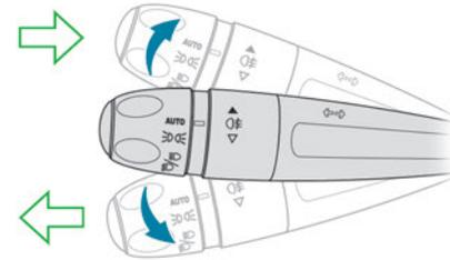
► Izquierda o derecha: baje o suba la palanca de las luces rebasando el punto de resistencia.
