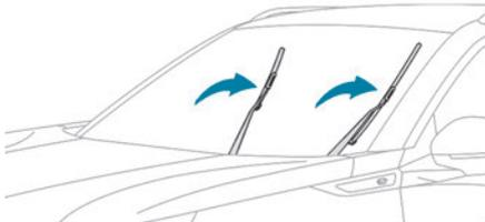
Accione la palanca de mando del limpiaparabrisas inmediatamente después de quitar el contacto para que las escobillas se coloquen en posición vertical.
