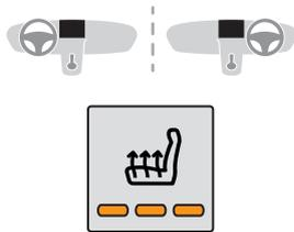
La función se activa sólo con el motor en marcha y con una temperatura exterior inferior a 20 °C.
