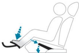
► Tire ligeramente de la palanca del freno de estacionamiento hacia arriba, pulse el botón de liberación y baje totalmente la palanca.
