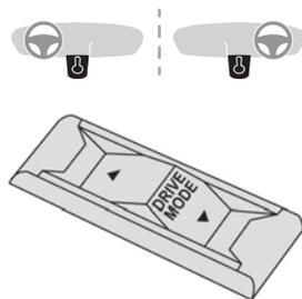
► Pulse el mando para visualizar los modos en el cuadro de instrumentos. En un vehículo eléctrico, no se puede seleccionar ningún modo al arrancarlo hasta que se muestre el testigo **READY**.
